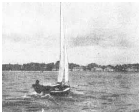
В этом случае площадь смоченной поверхности слишком велика. Накренив швертбот на подветренный борт, можно ее уменьшить, а также добиться уменьшения завихрения на корме.
