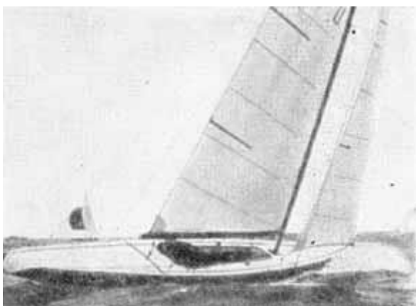
Этот стаксель является полной противоположностью тому, каким он должен быть. Он слишком полный в верхней части и слишком плоский в нижней.
