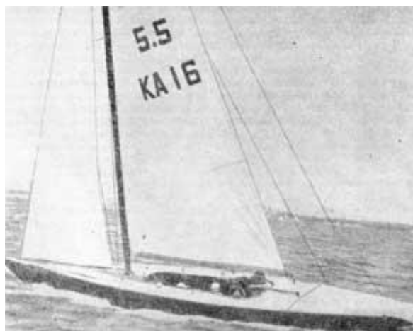
Вот пример того, как туго набиваются паруса в "5,5-метровом" классе и как круто яхты этого класса идут к ветру. Это возможно благодаря острой форме корпуса.
