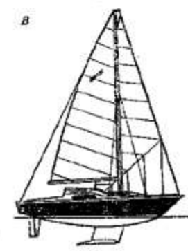
Рис. 13, Шлюпы: А — гафельный; Б — бермудский обычный (класс «470»); В — бермудский с топовым стакселем
